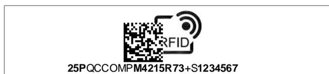
Bild 20) Unverwechselbar serialisierter Produktcode in DataMatrix und RFID
