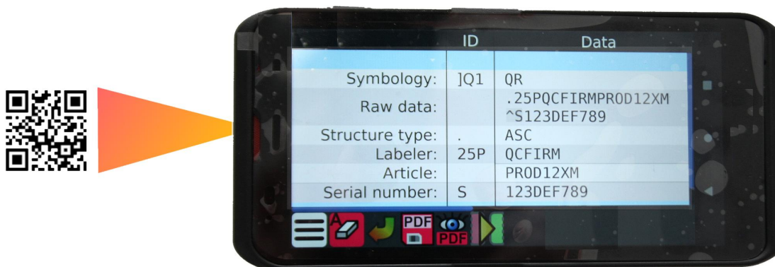
Abbildung 2) Smartphone-Scan und die per App offline interpretierten Daten des QR der Abbildung 1: Firmen-ID, Modell, Seriennummer (Bildquelle Elmicron).
