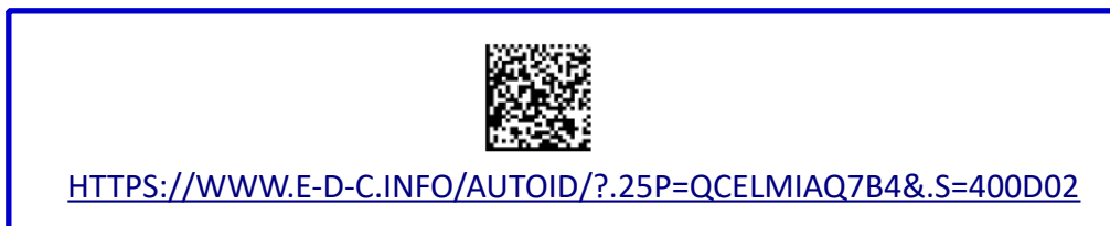
Abbildung 7) AutoID URL 1.0 codiert im DataMatrix führt zu der WEB-Seite des Motors mit der Seriennummer „400D02“.
